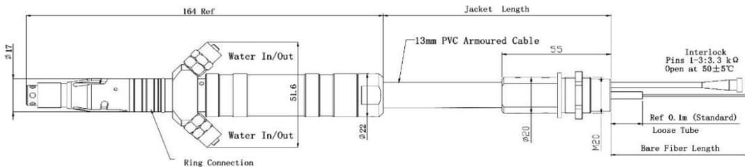
激光器工作前必须将输出头上两铜触点（Interlock pins）短接，否则激光器无法正常工作。
